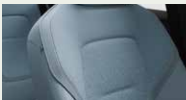
ピクセルニットの採用による裁断時の 廃棄物の出ない生地製造
